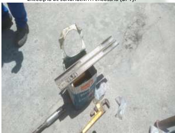
Foto 17 EXECUÇÃO DE SONDAGEM À PERCUSSÃO (SPT).
