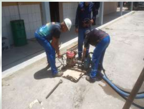
Foto 08 EXECUÇÃO DE SONDAGEM À PERCUSSÃO (SPT).
