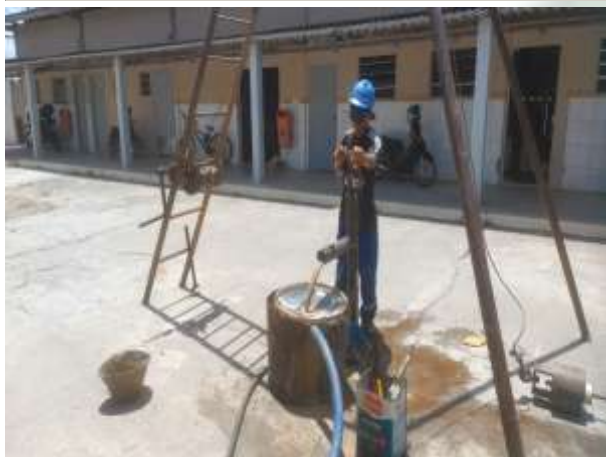
Foto 13 EXECUÇÃO DE SONDAGEM À PERCUSSÃO (SPT).
