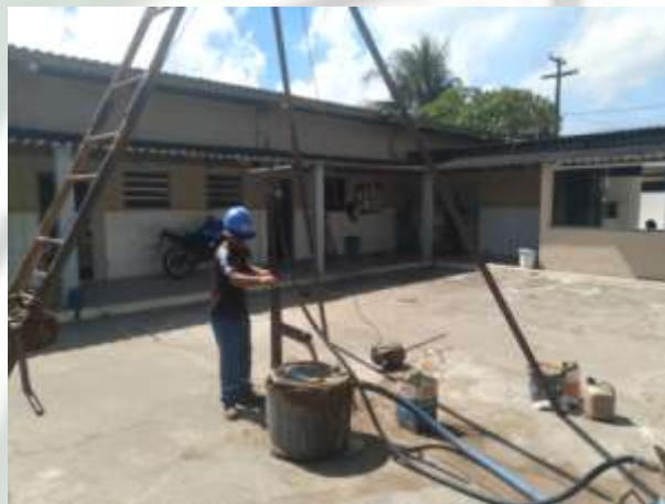
Foto 02 EXECUÇÃO DE SONDAGEM À PERCUSSÃO (SPT).
