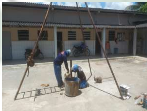
Foto 06 EXECUÇÃO DE SONDAGEM À PERCUSSÃO (SPT).
