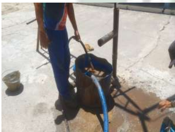
Foto 15 EXECUÇÃO DE SONDAGEM À PERCUSSÃO (SPT).
