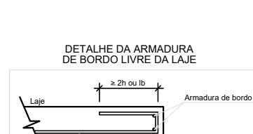
DETALHE DA ARMAÇÃO DE BORDA DA LAJE
