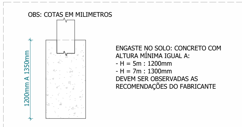
POSTE AUXILIAR DUPLO T DE ENTRADA DE ENERGIA
