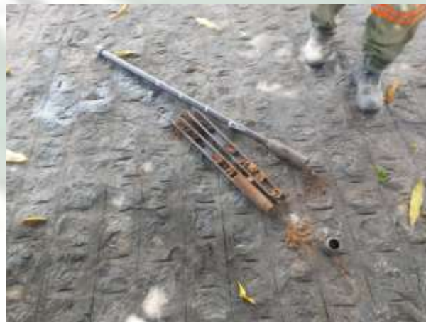
Foto 18 EXECUÇÃO DE SONDAGEM À PERCUSSÃO (SPT).
