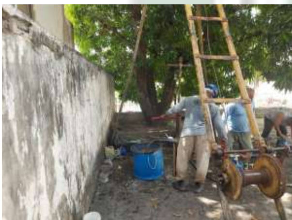
Foto 09 EXECUÇÃO DE SONDAGEM À PERCUSSÃO (SPT).
