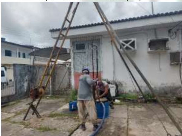
Foto 03 EXECUÇÃO DE SONDAGEM À PERCUSSÃO (SPT).
