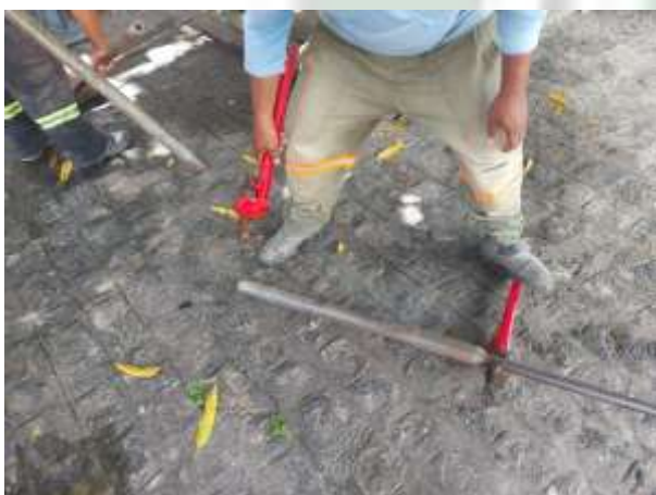
Foto 15 EXECUÇÃO DE SONDAGEM À PERCUSSÃO (SPT).
