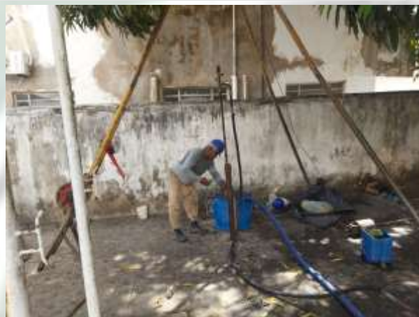
Foto 14 EXECUÇÃO DE SONDAGEM À PERCUSSÃO (SPT).
