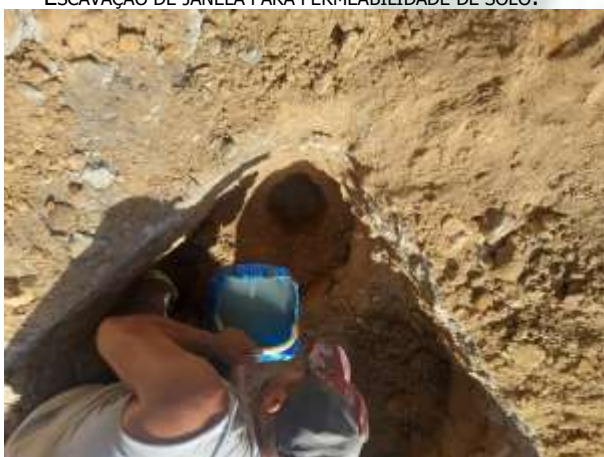
Foto 09 SATURAÇÃO DE JANELINHA ESCAVADA.
