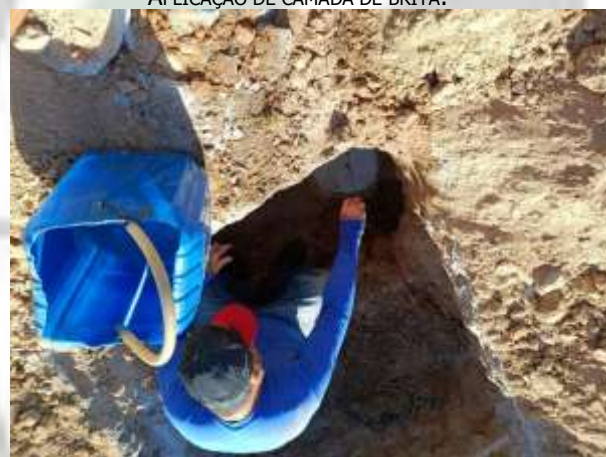
Foto 10 SATURAÇÃO DE JANELINHA ESCAVADA.
